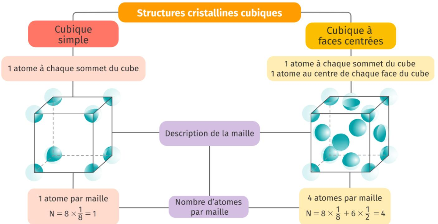
Le côté du cube, noté  $a$ , s'appelle « **paramètre de maille** ». Il est souvent donné en **picomètre** :  $1 \text{ pm} = 10^{-12} \text{ m}$
