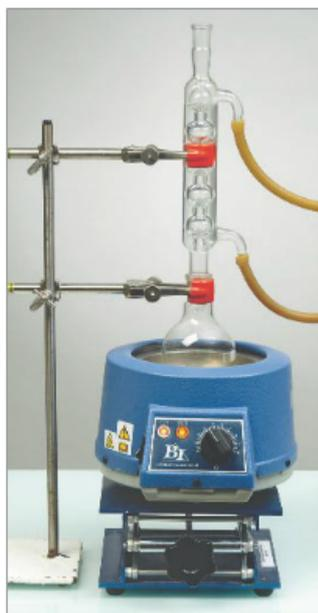
**11** Dispositif de chauffage à reflux.
