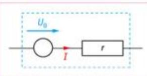
FIG. 4 Modélisation d'une source réelle de tension.
