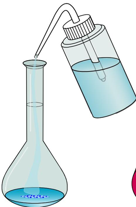
Remplir à moitié la fiole jaugée avec de l'eau distillée, boucher puis agiter jusqu'à dissolution complète du solide.
