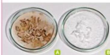
FIG. 7 Cristaux d'acide benzoïque avant **A** et après **B** recristallisation.
