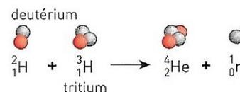
**Fig. 1 :** Fusion de deux noyaux isotopes de l'hydrogène, le deutérium et le tritium, pour former un noyau d'hélium (et un neutron).
